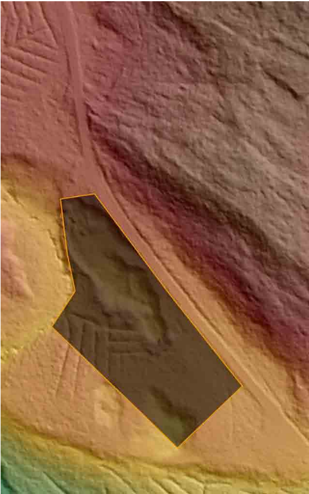
Laserbasert høydemodell av terrenget. Øverst i bildet ses eksisterende masseuttak. I midtre del synes grøfting i forbindelse med skogbruk. Området består av plantet gran og en del løvskog samt noe myr.
