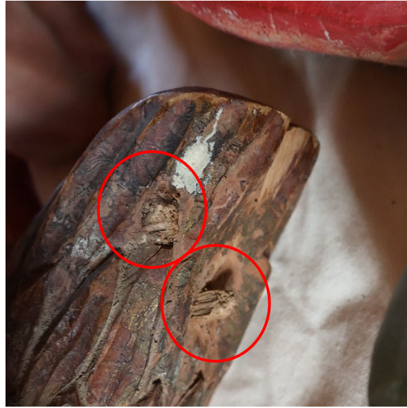
Fig. 16. Midt på ytterkanten av akantusvingene er det to hull med rester etter en avbrukket treplugg (t.v.). Disse samsvarer med bruddflaten på to avbrukkede treplugg på pelikanens stert (t.h.).
